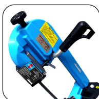
Leva di regolazione della tensione della lama
