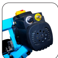
Variatore di velocità, pulsante di ripristino, spia di tensione
