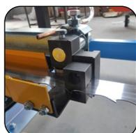
Guida e protezione della lama regolabili
