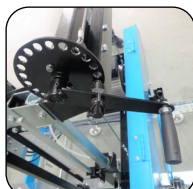
Manivela para ajustar la altura de corte
