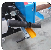
Mango de ajuste de la tensión de la cuchilla
