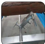
Sistema de retención de troncos
