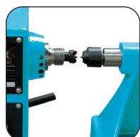
Mandrino di trasmissione CM2 filettato M33 x 3,5 mm
