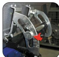
Guida in profilato di alluminio inclinabile a 45°
