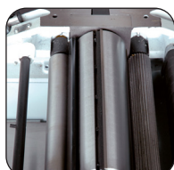
Albero di spianatura Ø 75 mm con 3 ferri 250 x 30 x 3 mm
