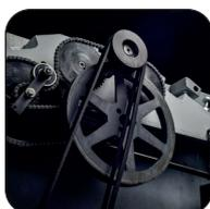
Rodillos accionados por cadena, accionamiento por motor de doble correa
