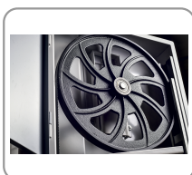
Uitgebalanceerde vliegwielen in gietstaal
