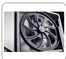
Uitgebalanceerde vliegwiel in gietstaal
