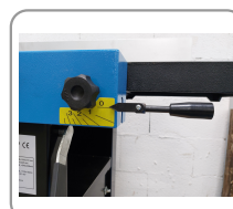
Réglage de la table d'entrée par levier excentrique
