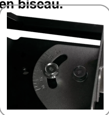
Mors arrière pivotant de -30° à +45°.
