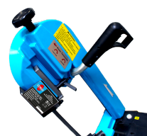
Handgreep voor het instellen van de spanning van het zaagblad
