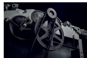
Kettingaandrijving, motoraandrijving met dubbele riem
