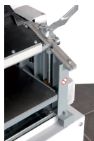
Schaafbank in gietstaal op 4 schroefvijzels
