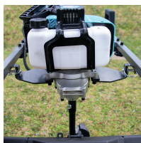
Montage du bloc moteur sur pivots
