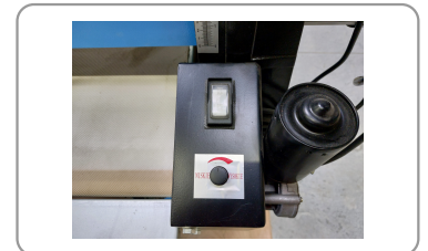
Moteur et boutons de commande indépendants pour le tapis de convoyage
