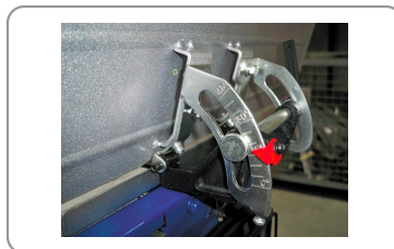
Guide en profilé aluminium inclinable à 45°
