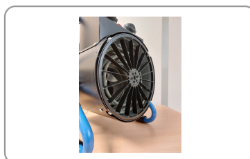
Ailettes canalisant le flux d'air
