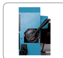
10 vitesses variables de 500 à 2000 tr/min
