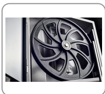
Volants en fonte d'acier équilibrés
