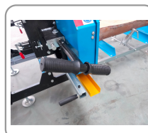
Poignée réglage pour la tension de la lame
