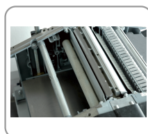
Rouleaux dentrainement pour l'avance de la pièce de bois
