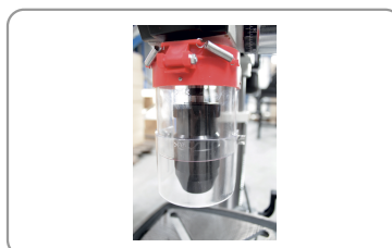
Carter de mandrin basculant et réglable
