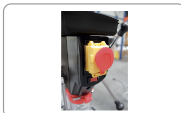
Bouton d'arrêt d'urgence coup de poing
