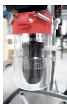
Carter de mandrin basculant et réglable
