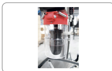
Carter de mandrin basculant et réglable
