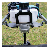
Montage du bloc moteur sur pivots
