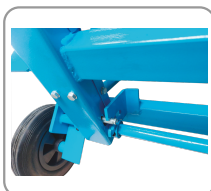
Interverrouillage du chariot de coupe et du protecteur supérieur.
