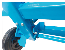
Interverrouillage du chariot de coupe et du protecteur supérieur.
