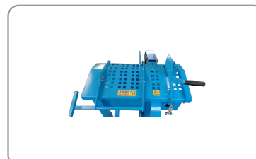
Protecteur supérieur avec poignée réglable et griffe de maintien de la bûche
