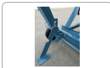
Interverrouillage du chariot et du protecteur supérieur
