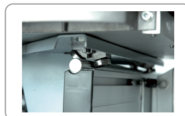
Chariot de tenonnage avec coulissement sur roulements à billes
