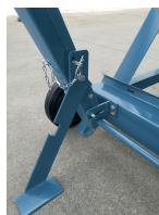
Interverrouillage du chariot et du protecteur supérieur
