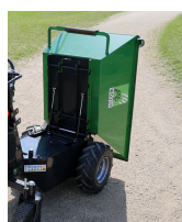
Benne à basculement manuel assisté par vérins à gaz
