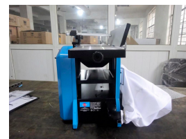
Système d'aspiration intégré (avec sac de récupération)
