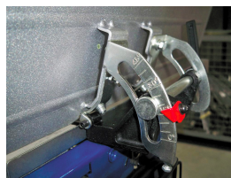
Guide en profilé aluminium inclinable à 45°
