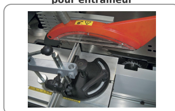
Chariot ras de lame 2000 mm, lame Ø 315 ou Ø 250 mm avec inciseur Ø 100 mm
