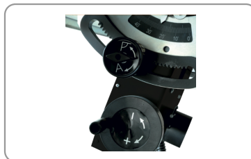
Lame inclinable à 45° et réglable en hauteur.
