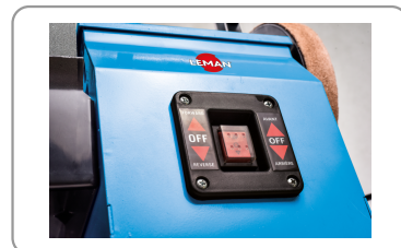
Interruttore on/off con selettore del senso di rotazione
