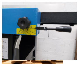
Réglage de la table d'entrée par levier excentrique
