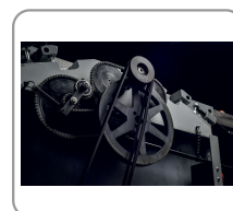
Alimentazione rulli a catena, trasmissione motore a doppia cinghia
