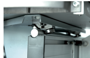
Carrello per tenoni con scorrimento su cuscinetti a sfera
