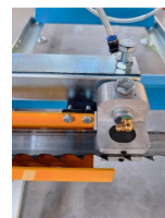
Guide de lame avec buse pour liquide de refroidissement
