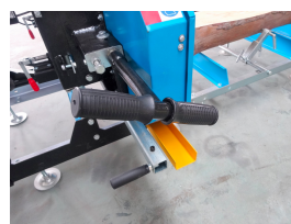
Maniglia di regolazione della tensione della lama
