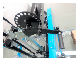
Manovella per la regolazione dell'altezza di taglio
