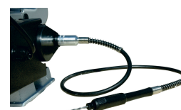
Flessibile con mandrino Ø 3 mm per microlavorazioni
