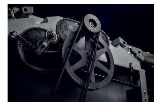
Alimentazione rulli a catena, trasmissione motore a doppia cinghia
