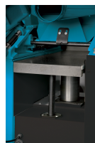
Banco di piallatura montato su 2 colonne
