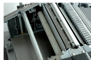
Rulli per l'avanzamento dell'elemento in legno
