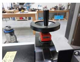
Réglage de la hauteur avec compteur à lecture directe
