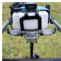
Montage du bloc moteur sur pivots
