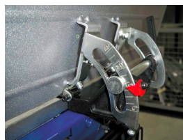
Guida in profilato di alluminio inclinabile a 45°
