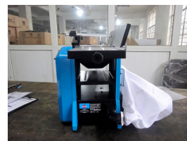
Sistema di aspirazione integrato (con sacchetto di recupero)
