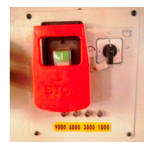
Toupie con 4 velocità di rotazione
