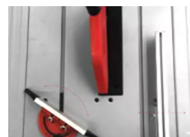
Guide d'angle réglable à 45°.
