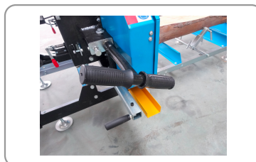
Maniglia di regolazione della tensione della lama
