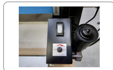
Moteur et boutons de commande indépendants pour le tapis de convoyage
