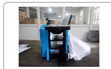
Sistema di aspirazione integrato (con sacchetto di recupero)
